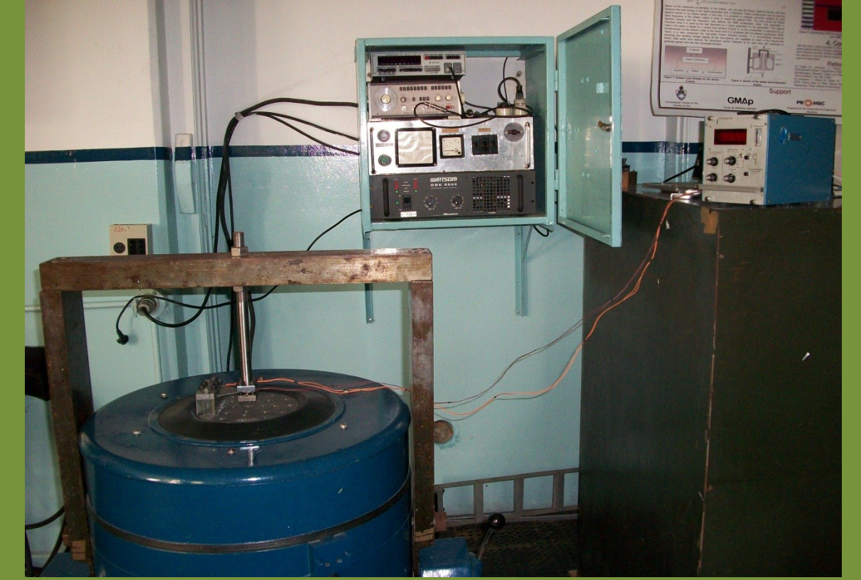
Shaker eletrodinâmico utilizado na pesquisa, disponível no laboratório do GMAp/UFRGS.
