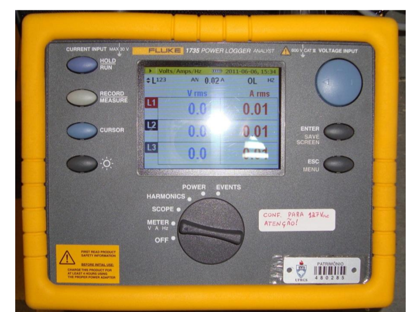
Figura 05. Analisador de energia.
