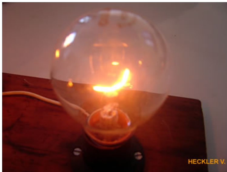
Figura 2.1.2- Filamento de uma lâmpada comum emitido luz pelo processo de radiação térmica.
