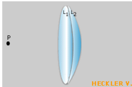
Simulação 8.6.2 - Associando-se duas lentes convergentes, elas conjugam o ponto objeto P com um ponto imagem P_2 .
