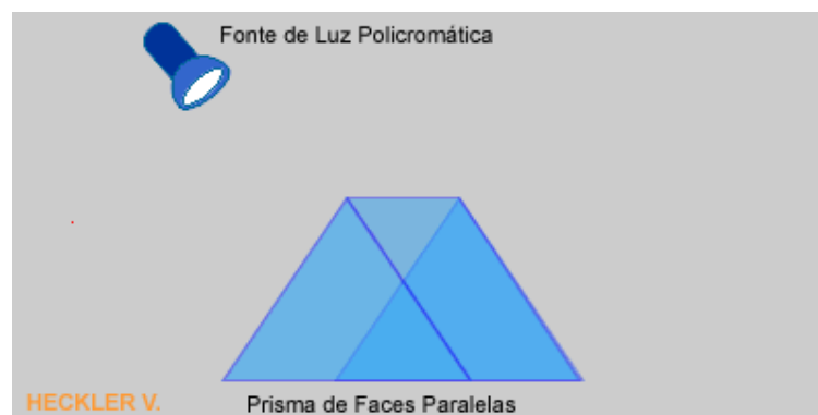
Simulação 7.7.1 - Simulando a dispersão da luz branca no prisma de faces paralelas.
