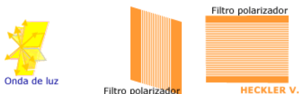
Simulação 11.1.2 - Uma onda de luz ao passar por dois filtros polarizadores perpendiculares entre si, nenhuma luz conseguirá passar.
