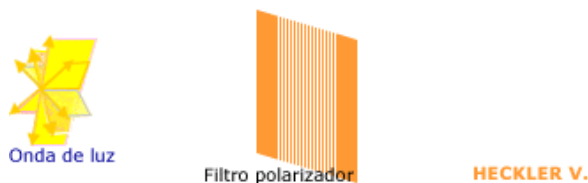
Simulação 11.1.1 - Uma onda de luz ao passar por um filtro polarizador irá se movimentar apenas em um plano.
