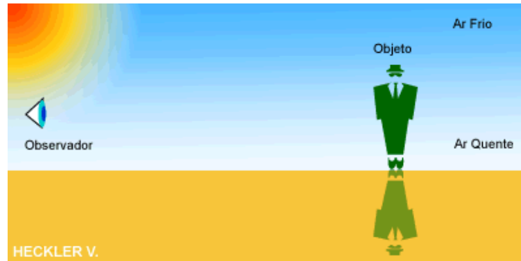
Simulação 7.4.1- Simulando a formação da miragem, a luz propaga-se mais rapidamente próximo ao solo onde a camada de ar é mais quente.
