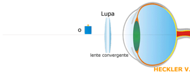
Simulação 8.7.2 - Simulação de uma imagem (O') visto a partir do objeto (O) com a lupa.
