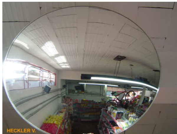
Figura 6.1.2 - Espelho esférico convexo utilizado como retrovisor em um supermercado.
