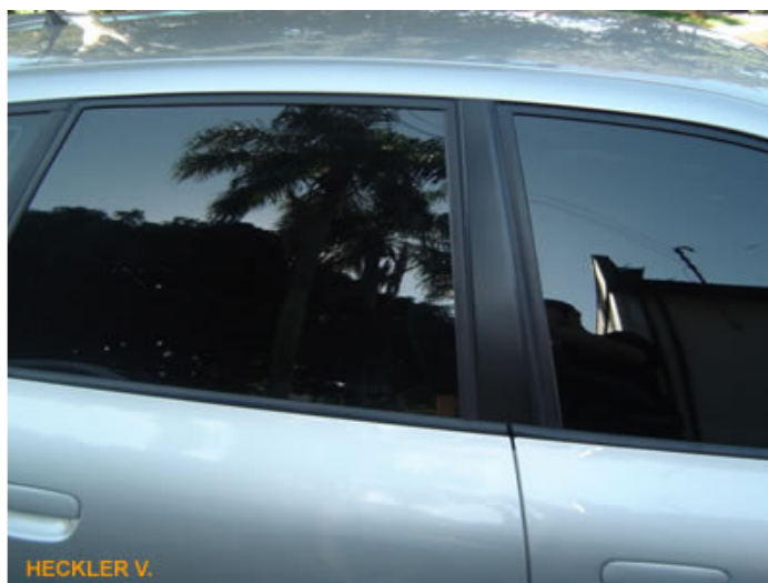
Figura 11.1.2 - Figura do resultado obtido com o uso de película polarizadora no vidro de um carro.
