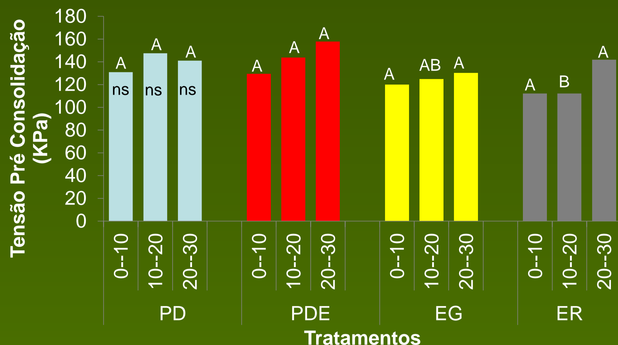
Figura 1: Tensão Pré-Consolidação nos diferentes tratamentos e profundidades em cm. Letras maiúsculas comparam tratamentos dentro da mesma profundidade. (Duncan P<0,05).
