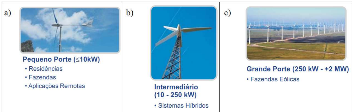
Figura 23 Aplicações de sistemas eólicos: a) Sistemas isolados; b) Sistemas híbridos e c) Sistemas interligados à rede elétrica. (Fonte: CEPTEL, 2008).
