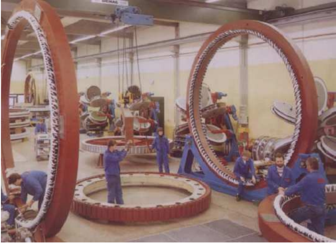
Figura 21 Fabricação de um gerador síncrono multipolo. (Fonte: ENERCON, 2007).
