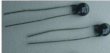
*Figura 8: Dois termistores do tipo NTC.*
