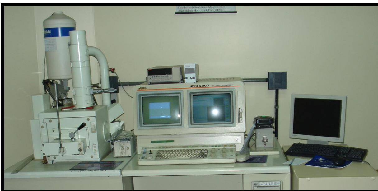
Figura 19 - MEV modelo JEOL JSM 5800 com EDS acoplado. Centro de Microscopia Eletrônica/UFRGS.
