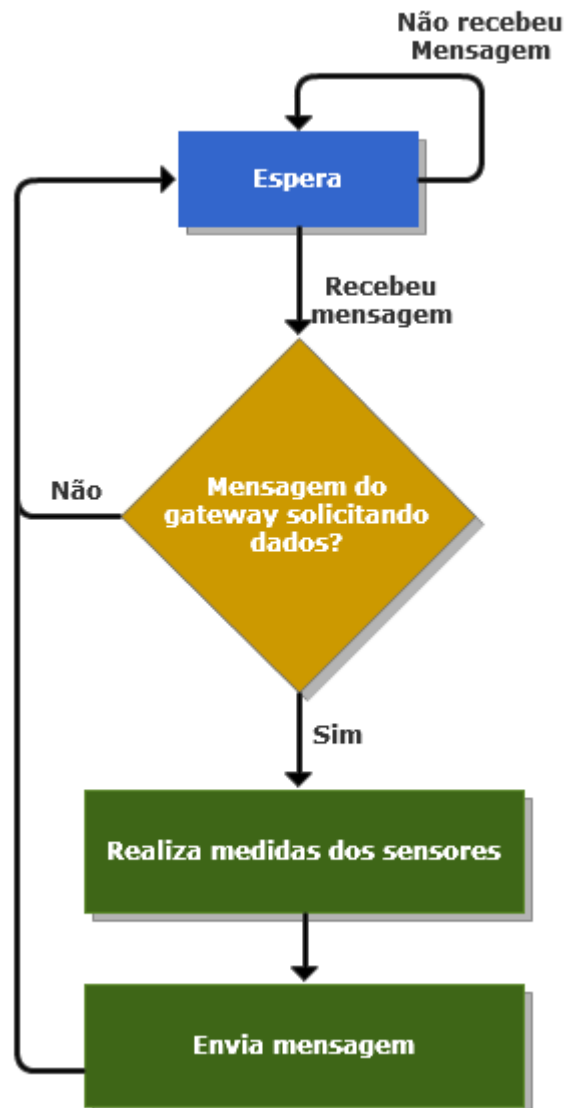
Figura 24. Fluxograma de operação – Nó Móvel.
