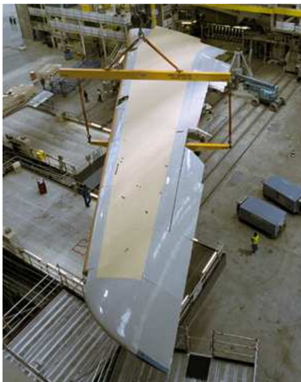
Figura 1.1 - Asa do A380, construída em materiais compósitos e com ligas de alumínio (cortesia da Airbus S. A. S).
