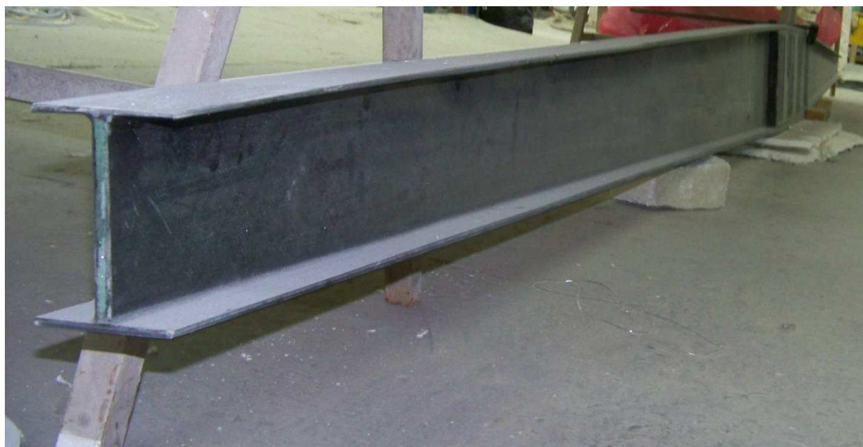
Figura AIII.1 – Longarina já fabricada.
