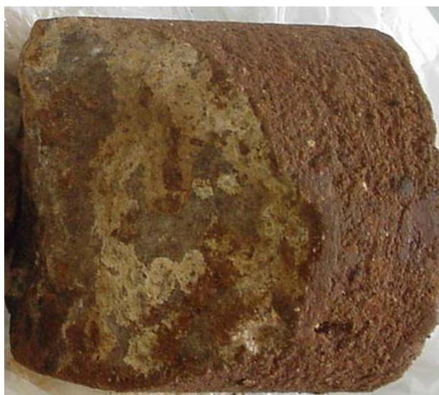
Figura 4.28 – Amostra extraída da base de solo-cal
