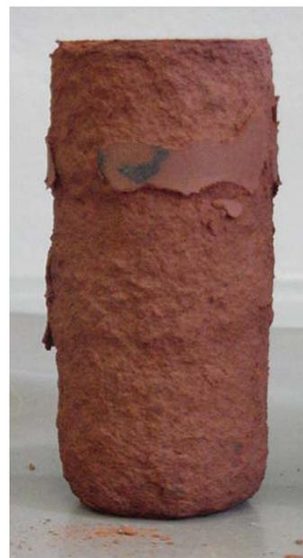
Figura 4.23 – Amostra submetida inicialmente a ciclo de secagem
