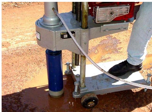
Figura 3.1 – Extração de amostras da pista
