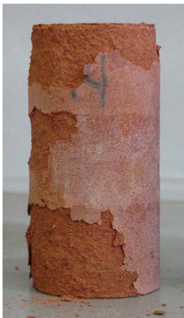
Figura 4.22 – Amostra submetida inicialmente a ciclo de molhagem
