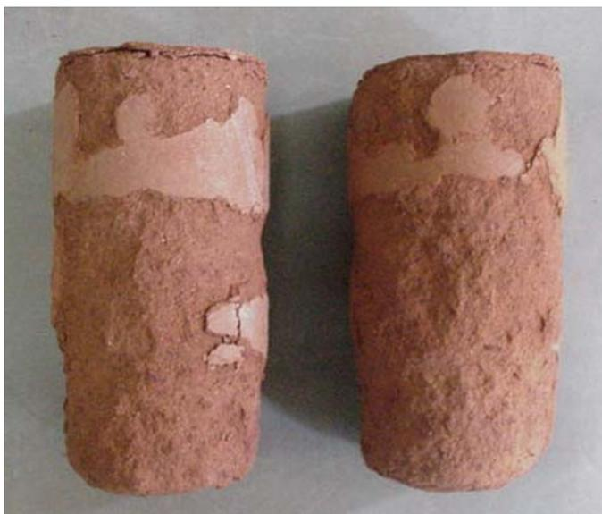
Figura 4.24 – Corpos de prova curados ao ar e submetidos a ciclos de molhagem e secagem
