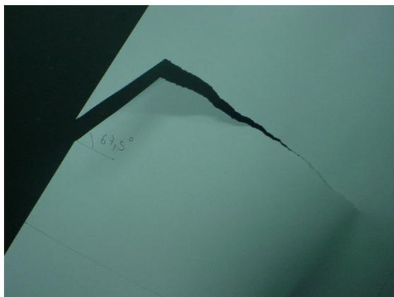
Figura 4.14 – resultado final do experimento com a propagação da trinca.
