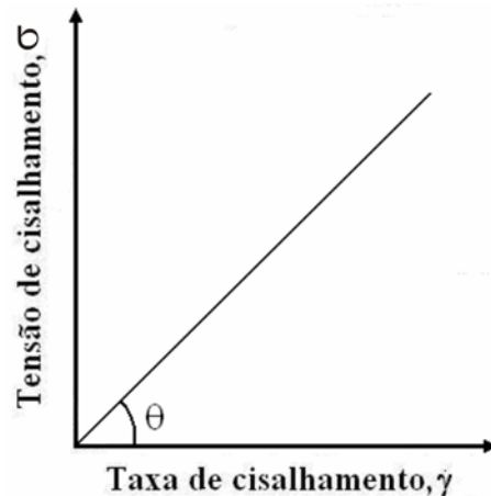
Figura 4. 8 - Curva de viscosidade para fluido Newtoniano (Fonte: MACHADO, 2007)
