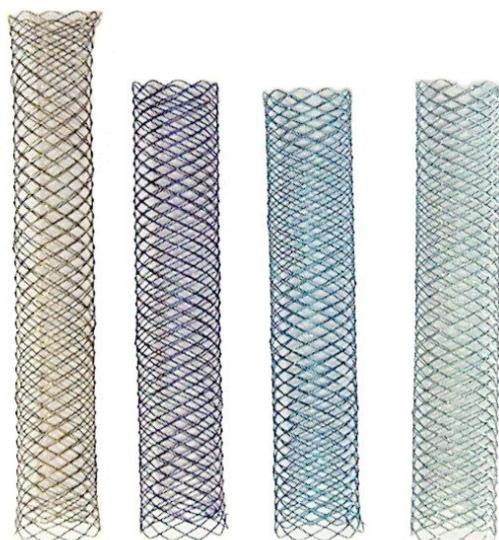
Figura 6.5 – Órteses após tratamento térmico, estando da esquerda para a direita as órteses: parda, roxa, azul escura e azul clara.
