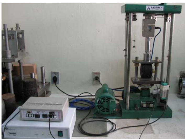
Figura 3.20 – Prensa para ensaio de RT por tração indireta instrumentada
