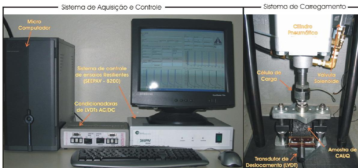
Figura 3.2 – Equipamento de ensaio de MR para misturas asfálticas do LAPAV/UFRGS
