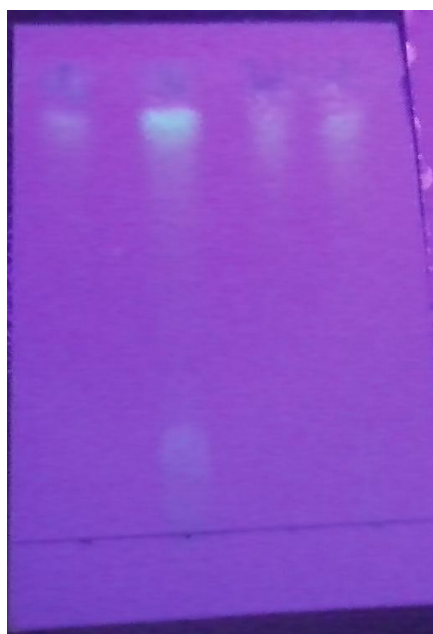
Figura 6. Cromatografia em camada delgada observada na luz UV (365 nm). A eluição foi realizada com acetato de etila. As amostras representadas, da esquerda para direita, são acetato de etila 1, metanol 1, acetato de etila 2, metanol 2.
