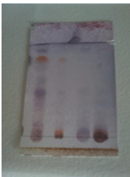
Figura 5. Cromatografia em camada delgada: extração das frações hexano 1, diclorometano1, hexano 2 e diclorometano 2, respectivamente.
