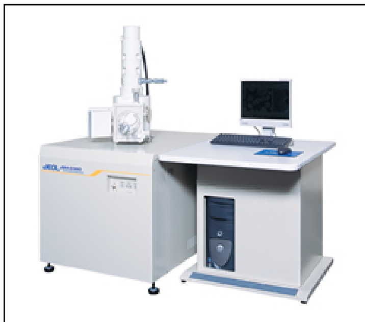
Figura 2.6: Microscópio eletrônico de varredura JEOL JSM 6060, do Centro de Microscopia Eletrônica (CME-UFRGS).
