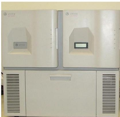
**Figura 11:** Forno de fluorescência por ultravioleta para ensaio de enxofre total marca Antek modelo 9000S
