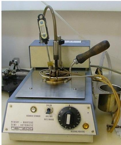
**Figura 9:** Equipamento Pensky-Martens semi-automático Herzog para ensaio do ponto de fulgor
