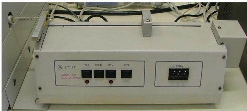
**Figura 13:** Sistema de injeção da amostra no analisador de enxofre.
