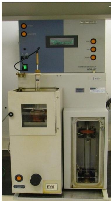
Figura 14: Destilador a pressão atmosférica marca Herzog modelo HDA 627.
