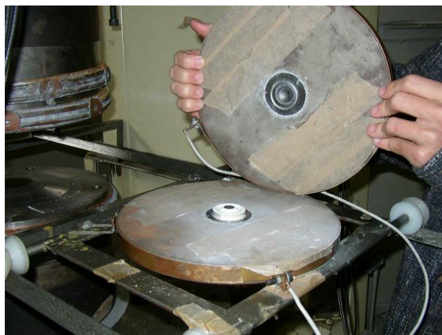
Fig. 7: Câmaras de perfil toroidal com cintamento de cobre, núcleo de carbeto de tungstênio e a configuração no centro.
