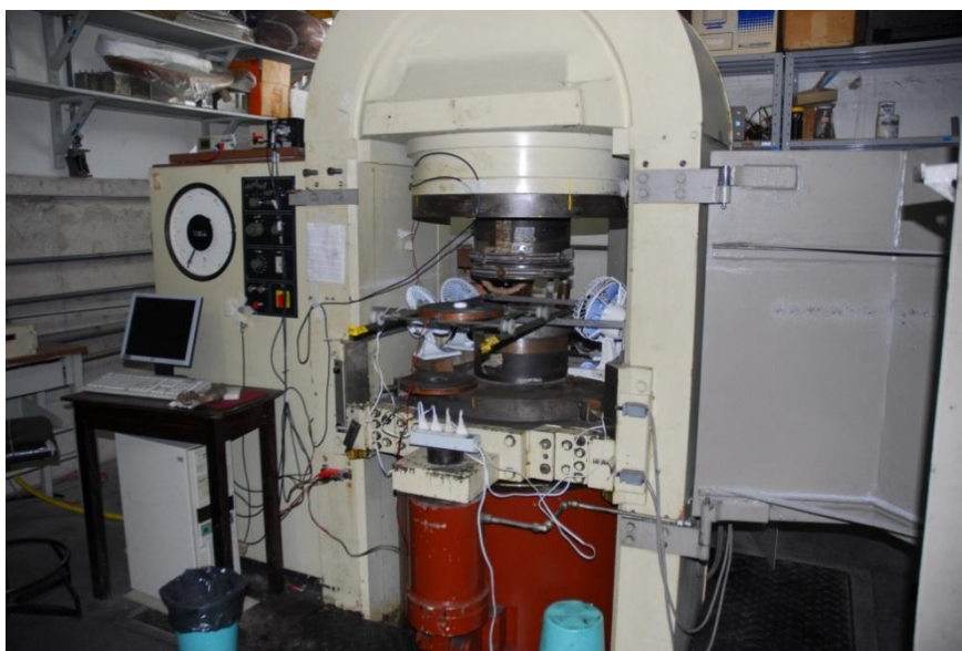
Fig. 6: Prensa de 1000tonf, onde são realizados os experimentos.
