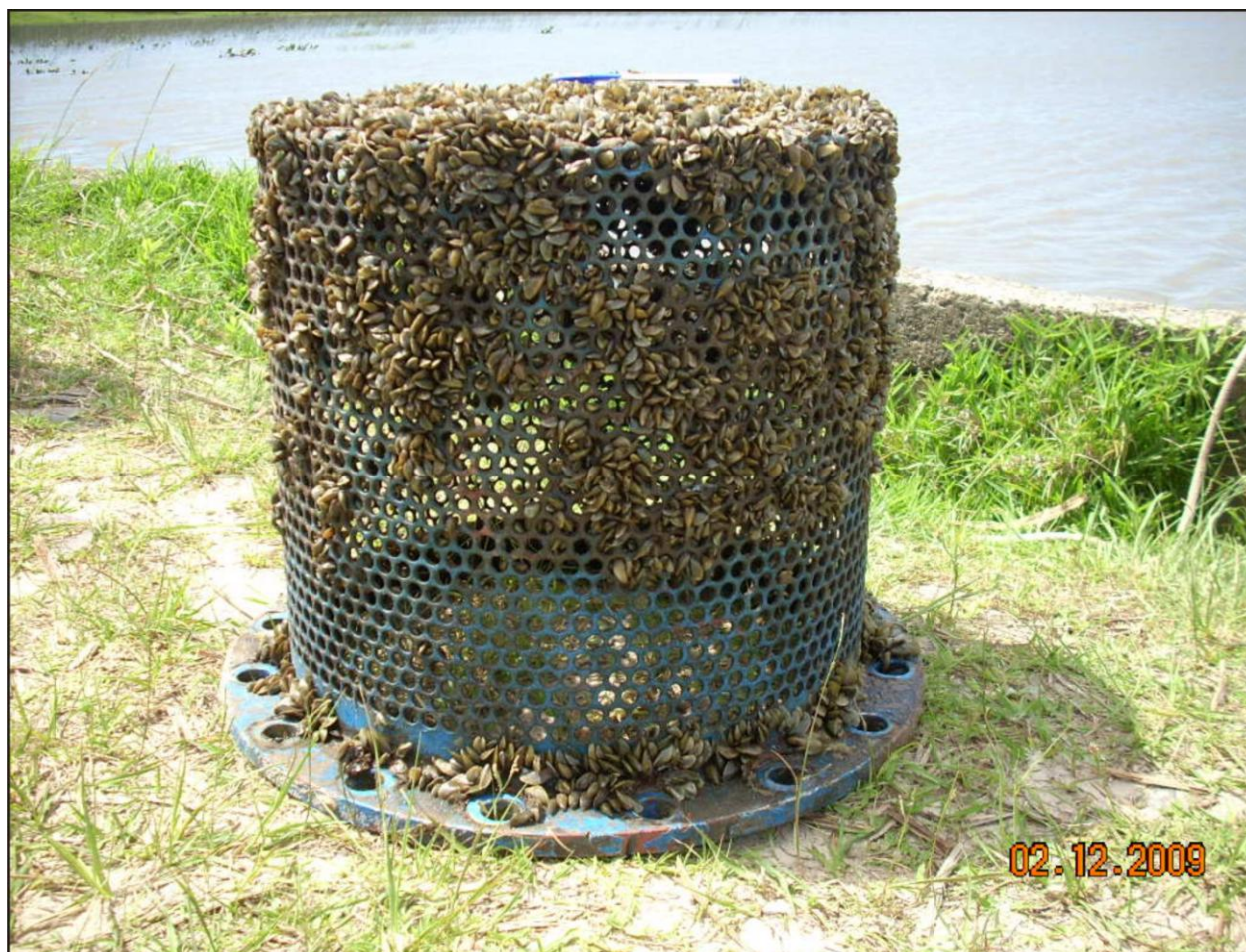
Figura 31. Crivo de bomba do sistema de captação de água de Capão da Canoa com incrustações de Limnoperna fortunei (Dunker, 1857). Fonte: Companhia Riograndense de Saneamento (CORSAN 2009).
