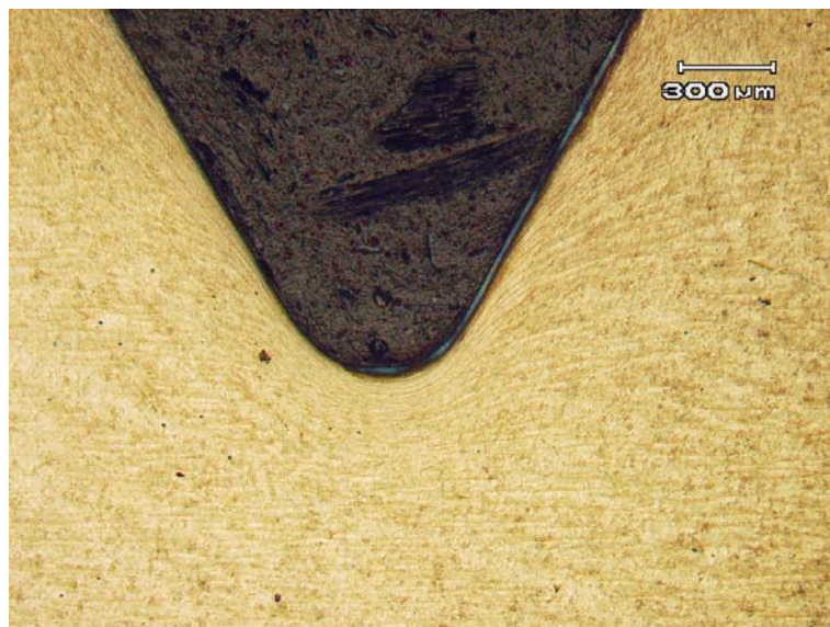
Figura 4.20- Micrografia típica de um dos prisioneiros mostrando fundo de filete obtido por laminação. Ataque: Nital 3%.
