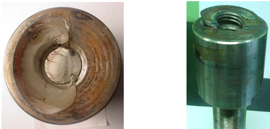
Figura 4.48- Fratura do prisioneiro Longo 03 no terceiro filete junto com o dispositivo. Carga 150kN e torque aplicado de 710Nm.
