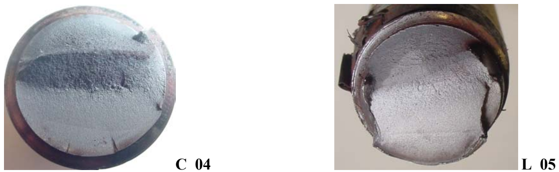
Figura 4.43- Fractografia das fraturas dos parafusos Curto 04 e Longo 05, ambos com carga externa aplicada de 200kN e torque 710Nm.
