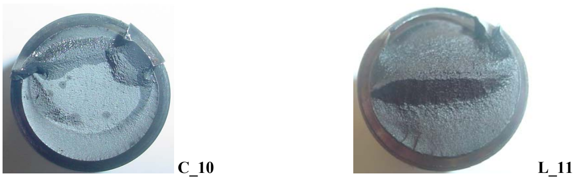
Figura 4.47- Fractografia das fraturas dos parafusos Curto 10 (23536 ciclos) e Longo 11 (724543 ciclos), ambos com carga externa aplicada de 260kN e torque 710Nm.
