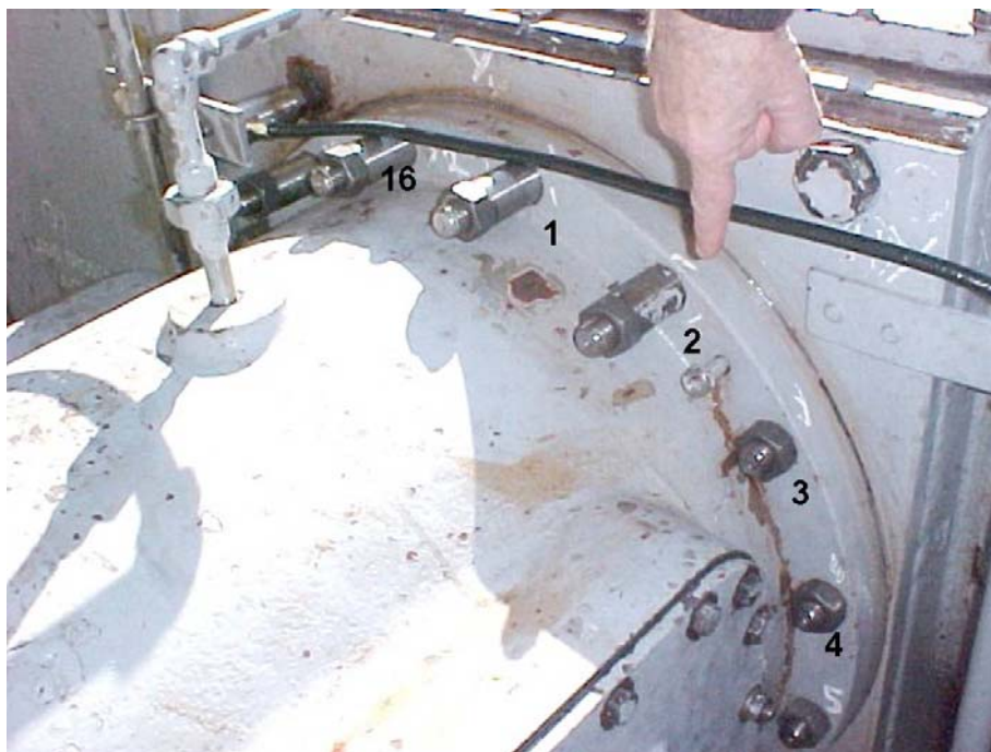
Figura 3.2- Ilustração do conjunto carcaça/corrediça do pré-compressor representando a numeração escolhida para identificação dos parafusos.
