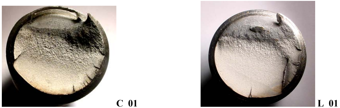
Figura 4.42- Fractografia das fraturas dos parafusos Curto 01 e Longo 01, ambos com carga externa aplicada de 150kN e torque 400Nm.
