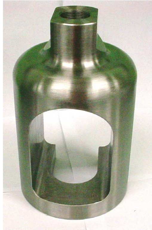
Figura 3.8- Ilustração do dispositivo suporte para ensaio de fadiga no atuador de 250kN.
