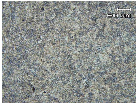
Figura 4.6- Micrografia mostrando a microestrutura da amostra formada por martensita revenida.
