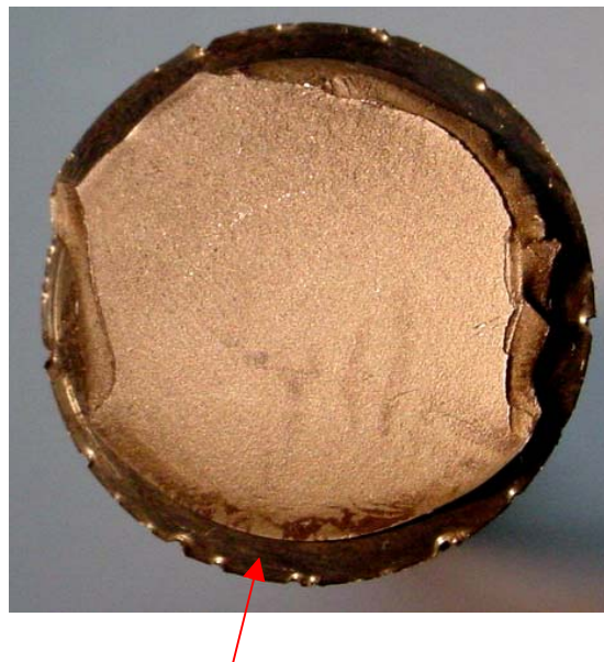
Figura 4.5- Imagem mostrando a superfície de fratura do parafuso tirante. A seta indica o início da falha.
