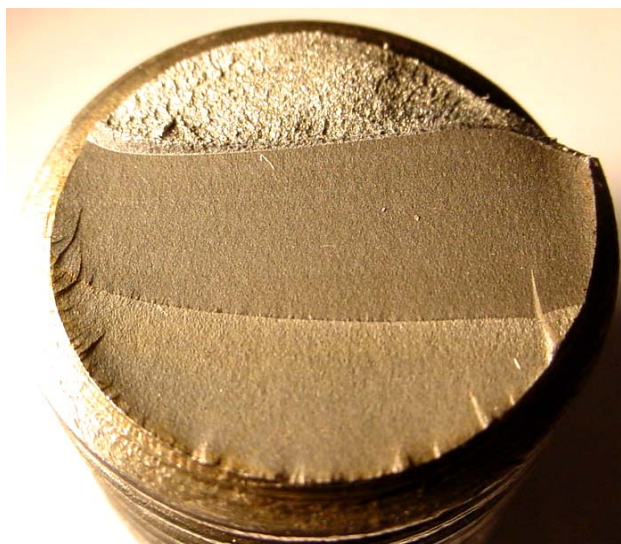
Figura 4.1- Macrografia mostrando a superfície de fratura do parafuso prisioneiro.
