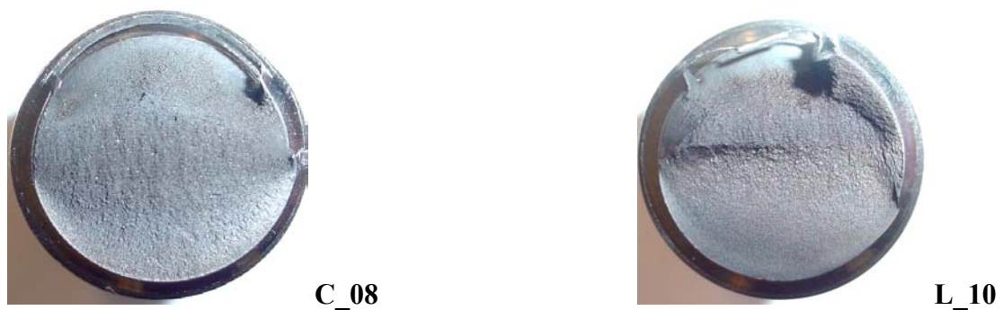
Figura 4.45- Fractografia das fraturas dos parafusos Curto 08 e Longo 10, ambos com carga externa aplicada de 220kN e torque 710Nm.
