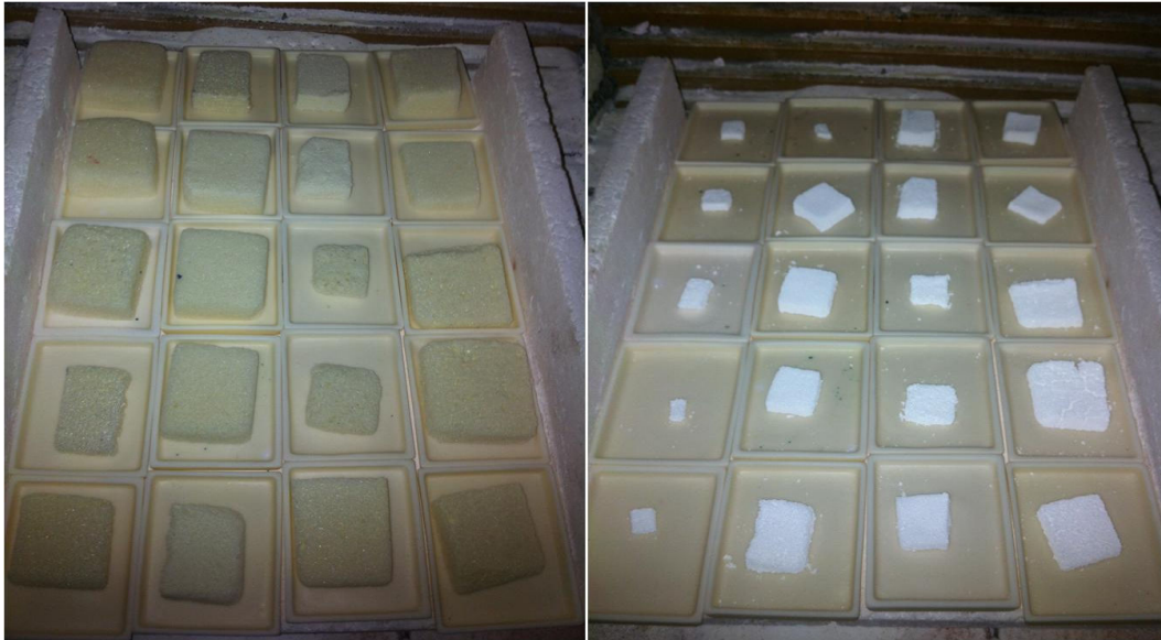
Figura 30 - Fotografias das amostras antes (à esquerda) e depois (à direita) da queima.
