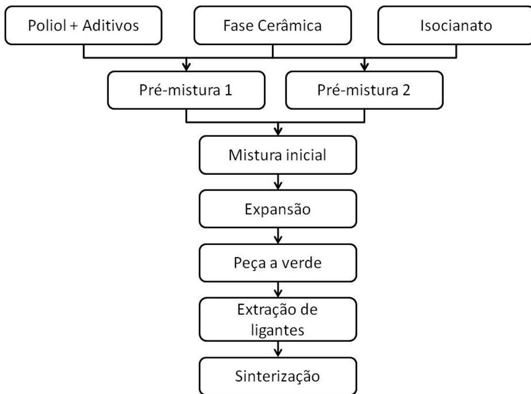
Figura 11 - Processo de gelcasting utilizando um sistema de PUR (2).
