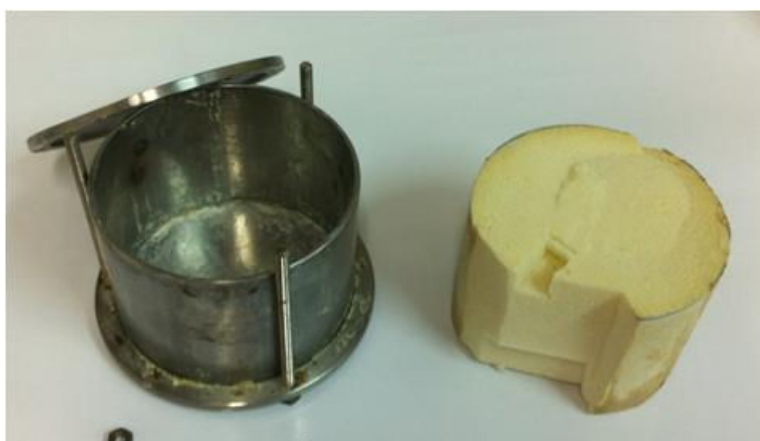
Figura 14 - Molde metálico e PUR após a conformação.
