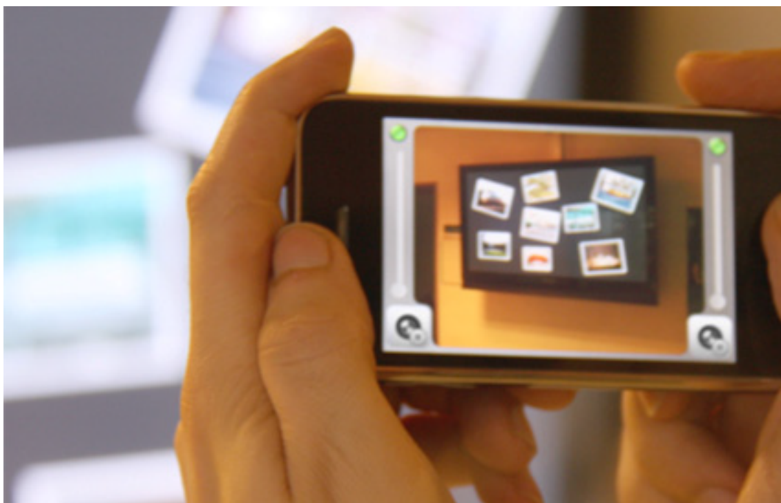
Figura 2.3: Câmera do celular filma a tela grande e, a partir da interpretação da posição dos itens, o usuário pode manipular os itens a partir da tela do celular (BORING et al., 2010).
