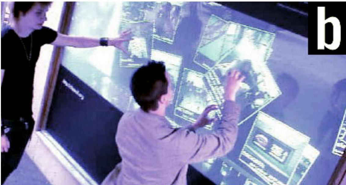
Figura 2.2: Dois usuários interagindo com o City Wall a partir do reconhecimento de gestos executados sobre a tela (PELTONEN et al., 2008).
