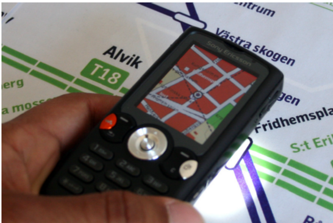
Figura 2.4: LED traseiro do celular ilumina a tela semitransparente e a luminosidade é captada por uma câmera colocada atrás da tela. A partir disso, o sistema identifica a posição do celular e envia para ele informações para serem mostradas em sua tela (OLWAL, 2006).
