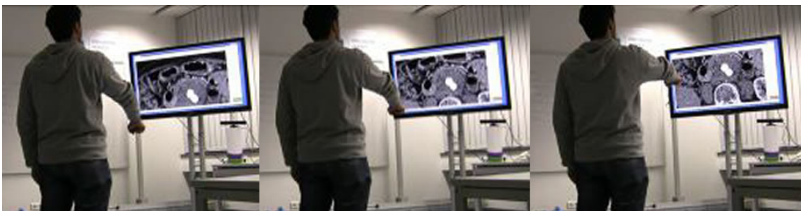
Figura 2.13: Usuário realizando um gesto para transladar verticalmente uma imagem, erguendo o braço direito (BIGDELOU et al., 2012).
