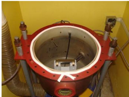
Figura 3.18 Equipamento para ensaio de corrosão-fadiga aberto mostrando a configuração do corpo de prova sobre o suporte inferior dentro da cuba de ensaio.
