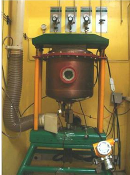
Figura 3.17 Equipamento desenvolvido no grupo GECOR utilizado para ensaios de corrosão-fadiga.
