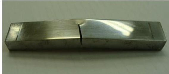
Figura 4.6 Perfil das fraturas encontradas nos corpos de prova ensaiados em fadiga ao ar do aço API 5CT P110.
