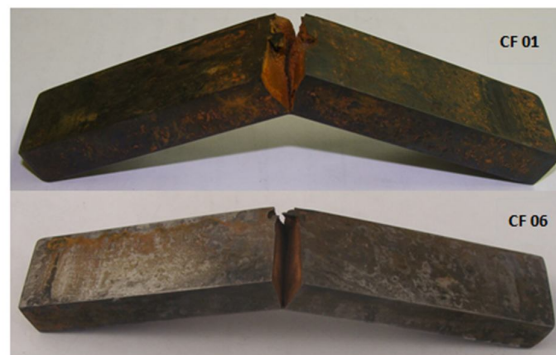
Figura 4.10 Perfil das fraturas encontradas nos corpos de prova ensaiados em corrosão-fadiga do aço API 5CT P110 dos corpos de prova CF 01 e CF 06.
