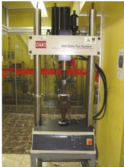
Figura 3.12 Máquina MTS modelo 858, já com o dispositivo e o corpo de prova posicionados.
