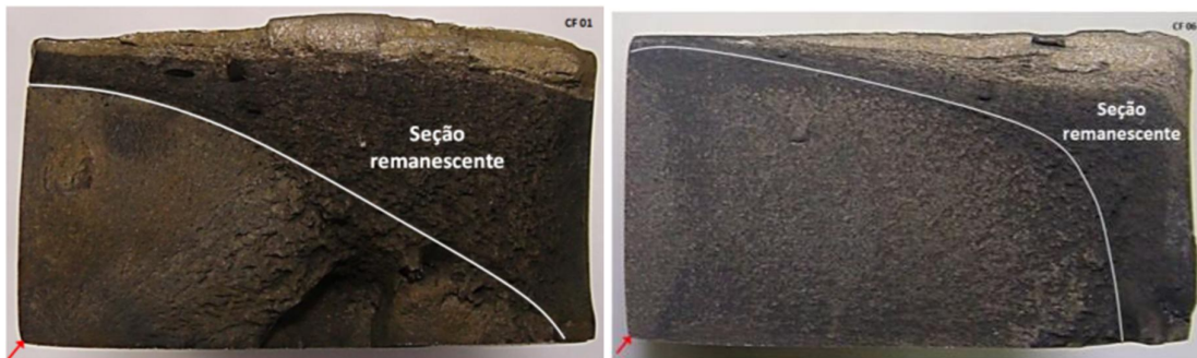
Figura 4.12 Superfície de fratura dos corpos de prova CF 01 e CF 06 do ensaio de corrosão-fadiga , submetidos à maior e menor tensão aplicada respectivamente. As setas indicam o local de iniciação da fratura.
