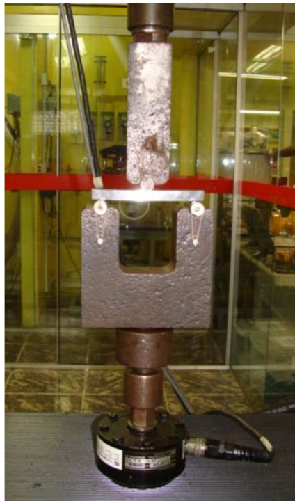
Figura 3.13 Dispositivo montado para o ensaio de fadiga ao ar.
