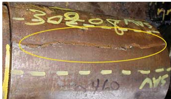
Figura 2.24 Fratura causada por SSC em uma conexão de aço API exposto a ambiente contendo baixo e médio teor de H_2S submetido a altas pressões internas (CHAFFIN et al, 2008).
