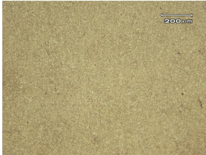
Figura 4.4 Micrografia do metal estudado. Aumento 100x. Reagente NITAL 2%.
