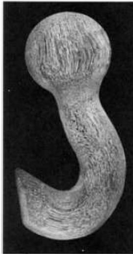
Figura 4 Gancho de aço forjado SAE 4140 mostrando a estrutura fibrosa (linhas de fluxo), resultante de forjamento a quente [17]
