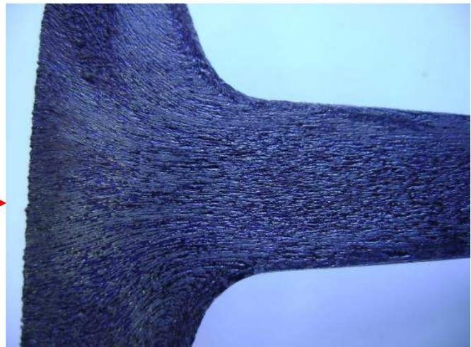
Figura 34 Fibragem da Configuração B
