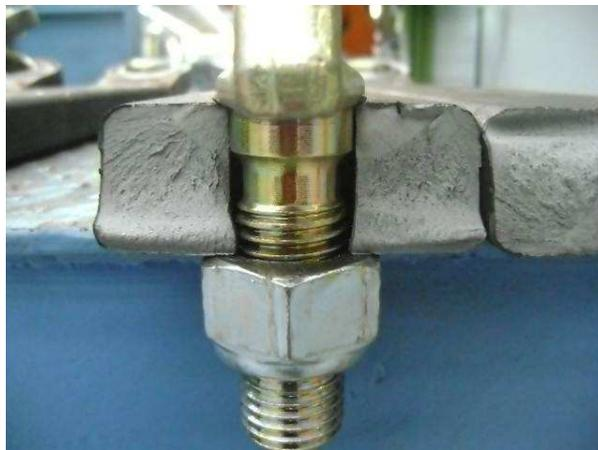
Figura 12 Fadiga em barra de sistema de levante de trator após ensaio de fadiga
