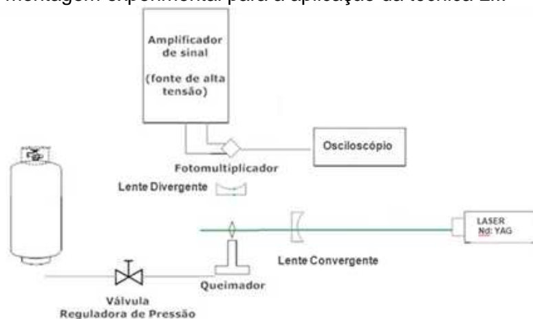
Figura 3.4: Desenho esquemático da bancada experimental para aplicar LII.
