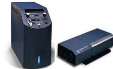
Figura VII: Laser Nd: YAG utilizado para a excitação das partículas de fuligem.
