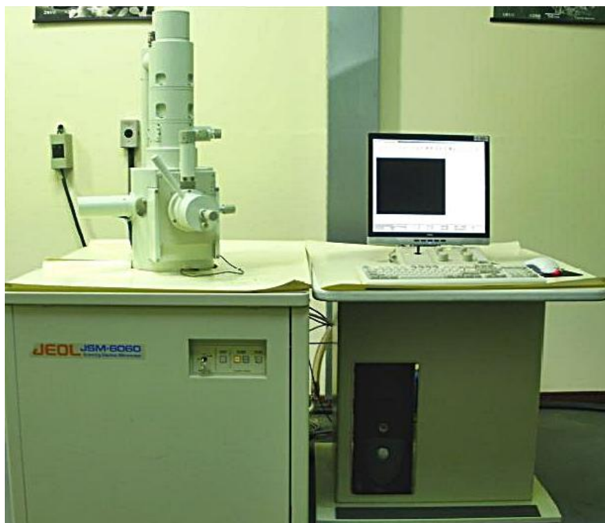
Figura 6: Microscópio eletrônico de varredura (MEV) utilizado para as observações das amostras.
