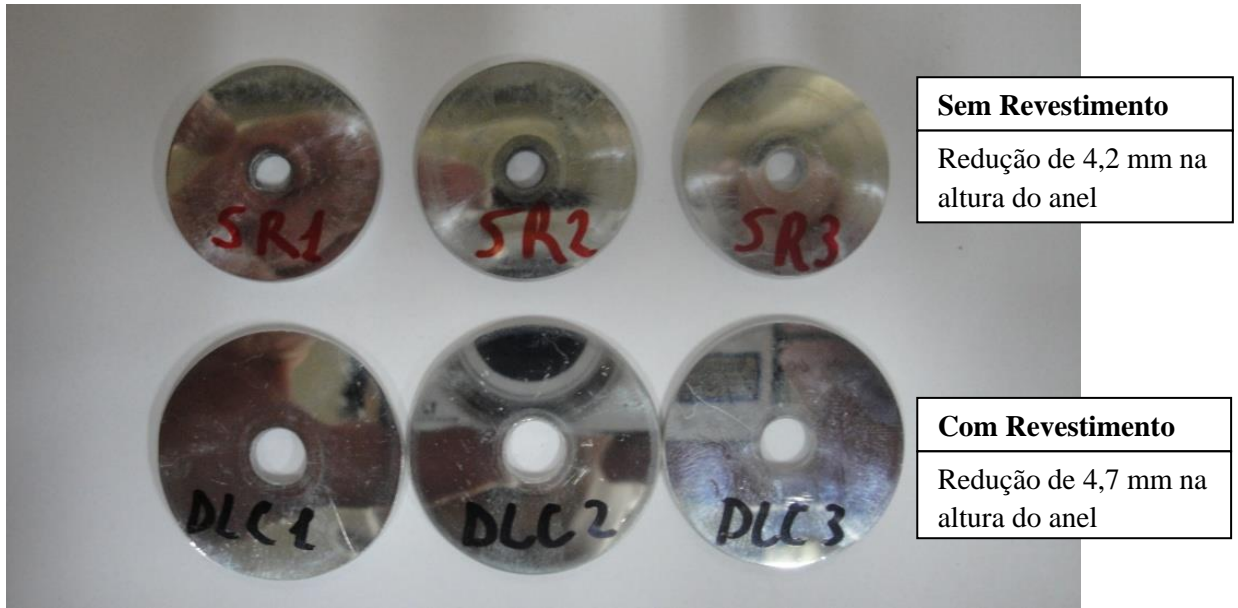
Figura 70. Geometria final dos anéis comprimidos sem lubrificação. Anéis superiores: conformados com matrizes polidas sem revestimentos. Anéis inferiores: conformados com a superfície Pol + Nitr + Pol + DLC 2.
