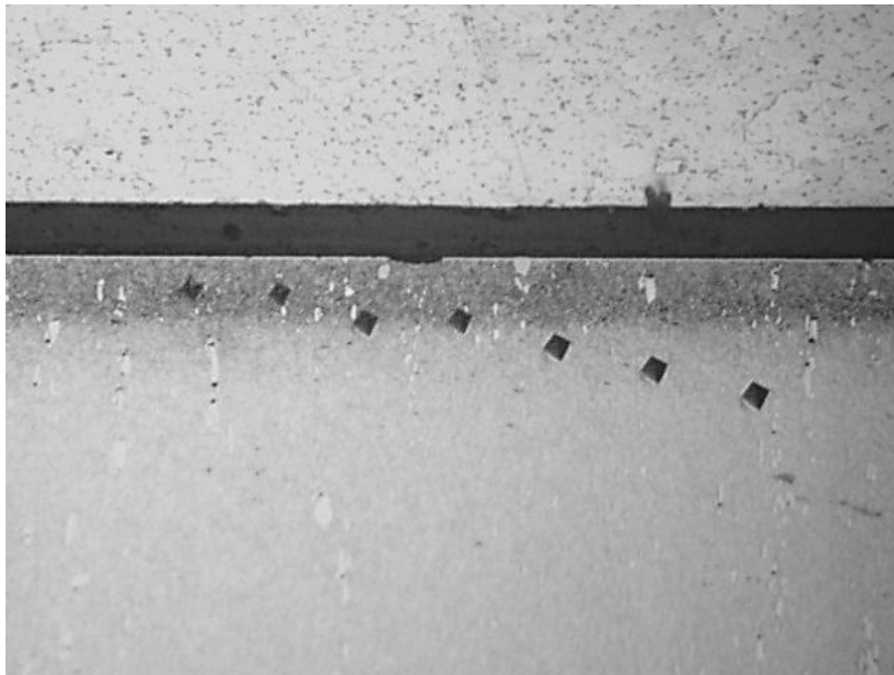
Figura 48. Seção Metalográfica da camada nitretada que não teve posterior polimento do aço DIN ~ X100CrMoV8-1-1.
