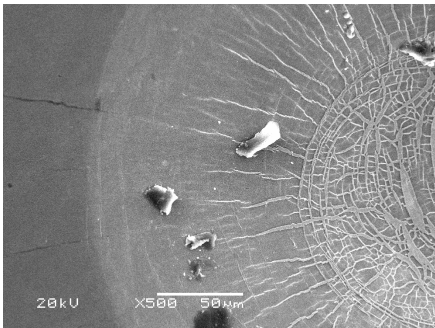
Figura 76. Microscopia Eletrônica de Varredura da amostra Pol + Nitr + Pol + DLC 1.
