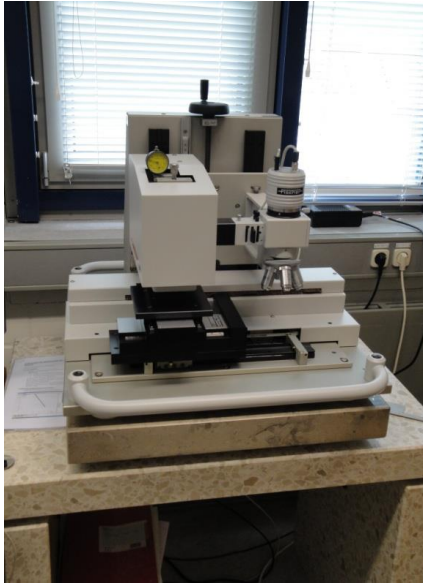
Figura 30. Equipamento para medição de ultramicrodureza do IWT-Bremen (a). Exemplo de aquisição de dados do equipamento através de software apropriado (b), adaptado de Both (7).
