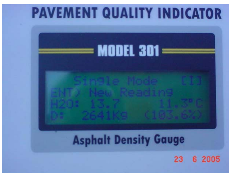
Figura 70: Uma vista do monitor do Densímetro Eletrônico registrando a densidade aparente do revestimento asfáltico
