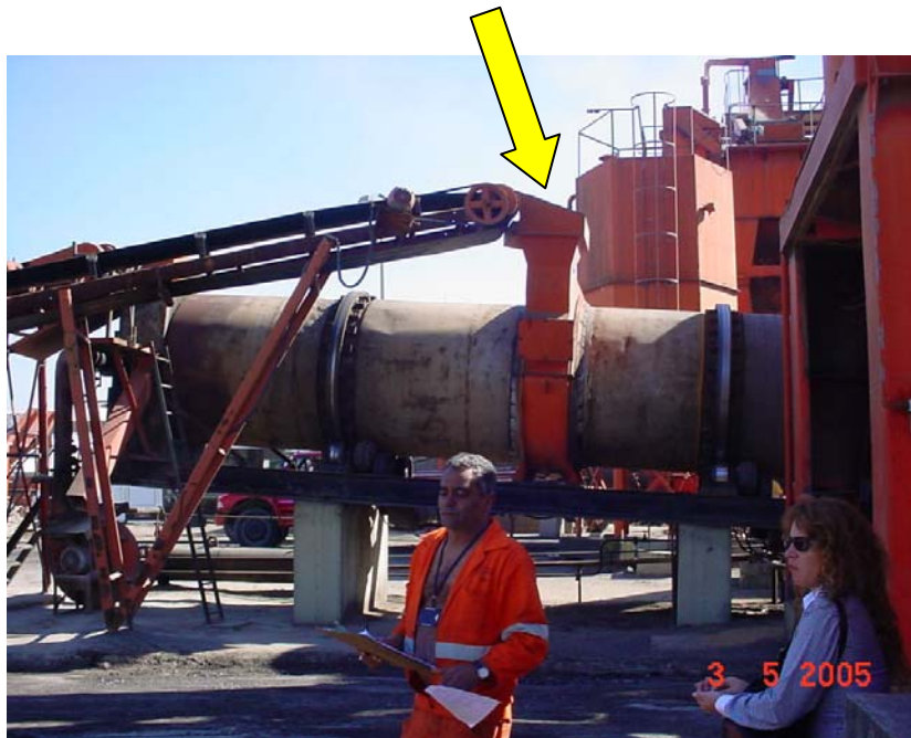
Figura 47: Detalhe da usina volumétrica onde entra a borracha pelo anel de reciclagem localizado após o queimador
