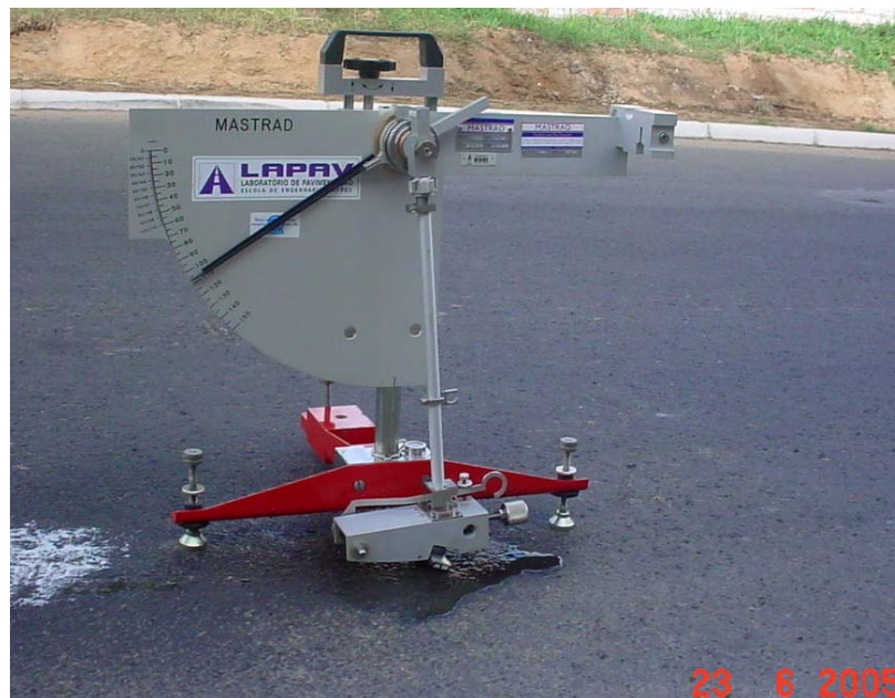
Figura 28: Equipamento portátil de avaliação das condições de segurança em termos de resistência a derrapagem tipo Pêndulo Britânico
