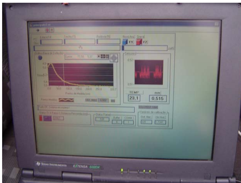
Figura 72: Tela do computador com o registro das leituras das deflexões
