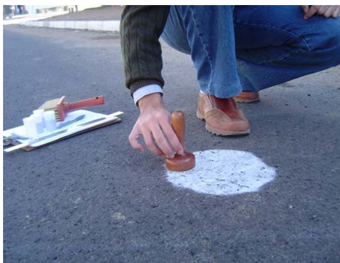
Figura 68: Realização do ensaio de mancha de areia
