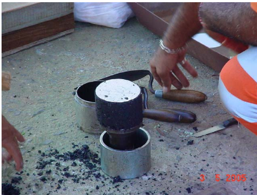
Figura 56: Corpo-de- prova moldados no local
