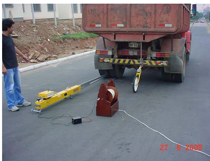
Figura 71: Realização do ensaio com a viga eletrônica
