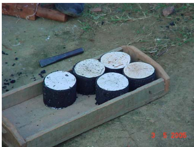
Figuras 58: Corpos-de-prova moldados no local com concreto asfáltico com incorporação de borracha reciclada de pneus
