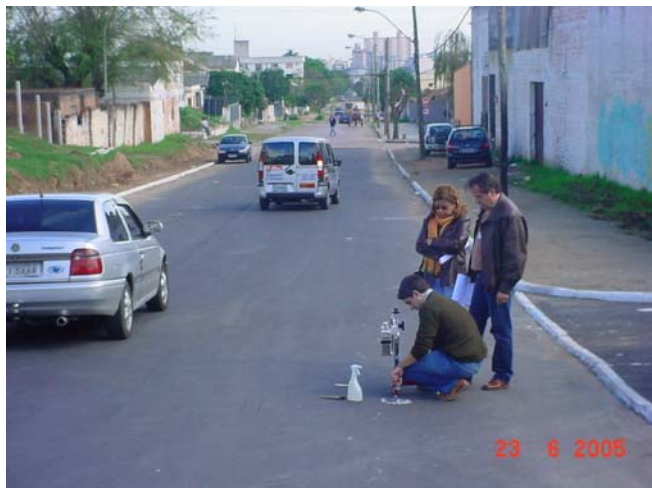
Figura 67: Realização do ensaio com o aparelho do tipo Pêndulo Britânico
