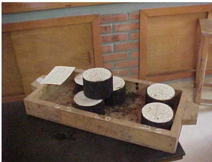
Figura 57: Corpos-de-prova moldados com concreto asfáltico convencional
