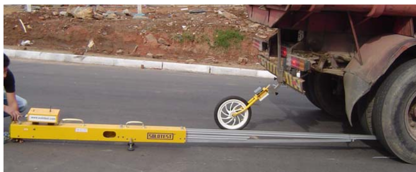
Figura 33: Viga eletrônica utilizada nesta pesquisa
