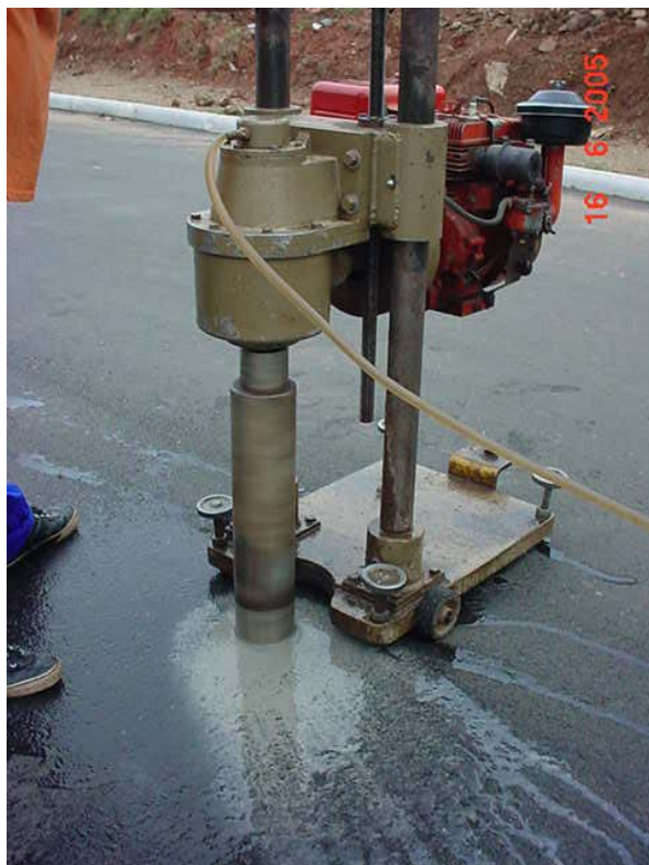
Figura 59: Extração de amostra para ensaios
