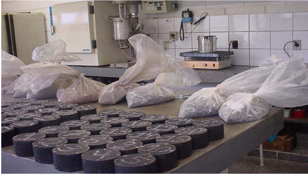
Figura 19: Corpos-de-prova moldados para a realização dos ensaios
