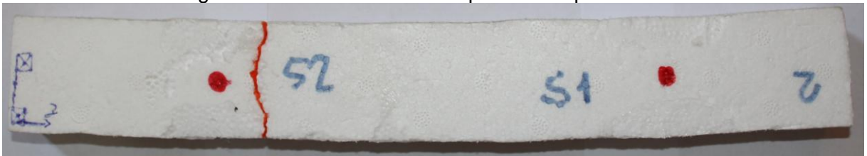
Figura AP-6- 5 – Amostra sem pré-trinca após ensaio.
