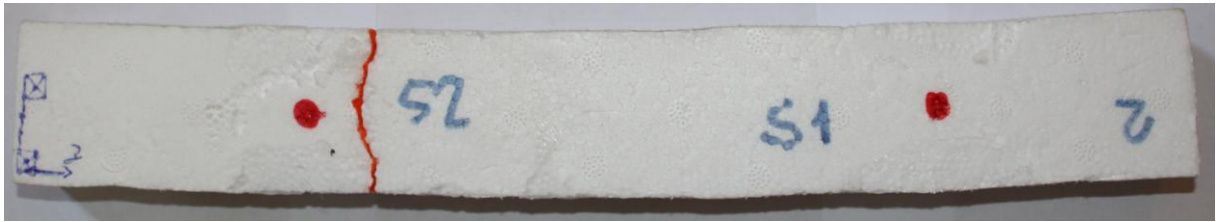
Figura 4-9 – Amostra ensaiada sem pré-trinca rompida.
