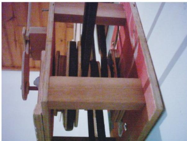
Figura 13b. Detalhe de mecanismo de distribuição de tração.
