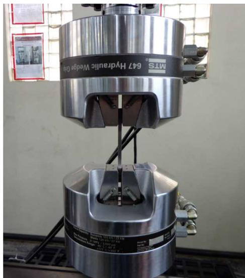
Figura 3.14: Posicionamento e fixação dos corpos de prova para ensaio de fadiga.
