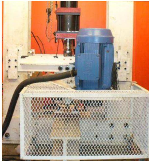
Figura 3.3: Equipamento para soldagem por fricção dos tubos.
