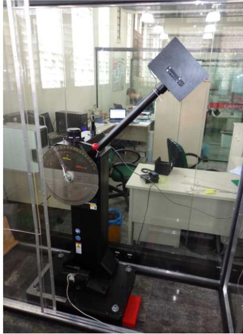
Figura 3.15: Equipamento para ensaio de Impacto (Charpy).
