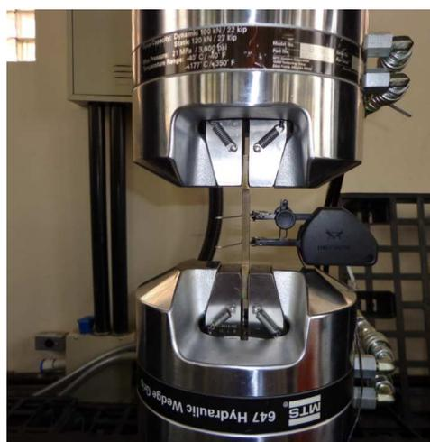
Figura 3.12: Posicionamento e fixação do corpo de prova no ensaio de Tração.
