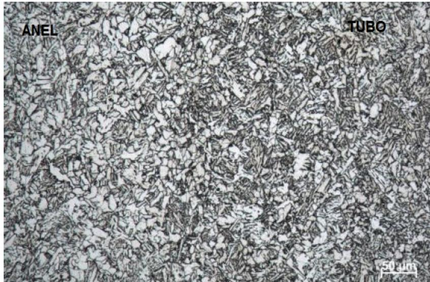
Figura 2.16: Microestrutura da interface tubo/anel. Solda realizada com 86,5 MPa de pressão de forjamento adaptado de (FAES et al. 2008b).
