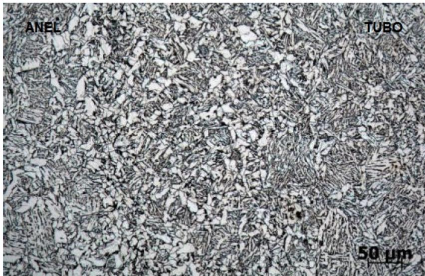
Figura 2.17: Microestrutura da interface tubo/anel. Solda realizada com 176,8 MPa de pressão de forjamento adaptado de (FAES et al. 2008b).
