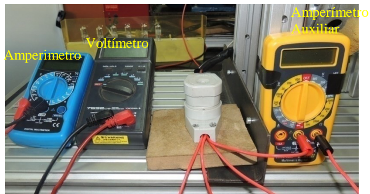
Figura 4.4 – Voltímetro e amperímetros utilizados para realização do ensaio.
