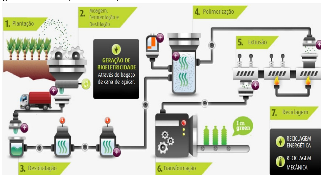
Figura 7 - Processo produtivo do polietileno verde
