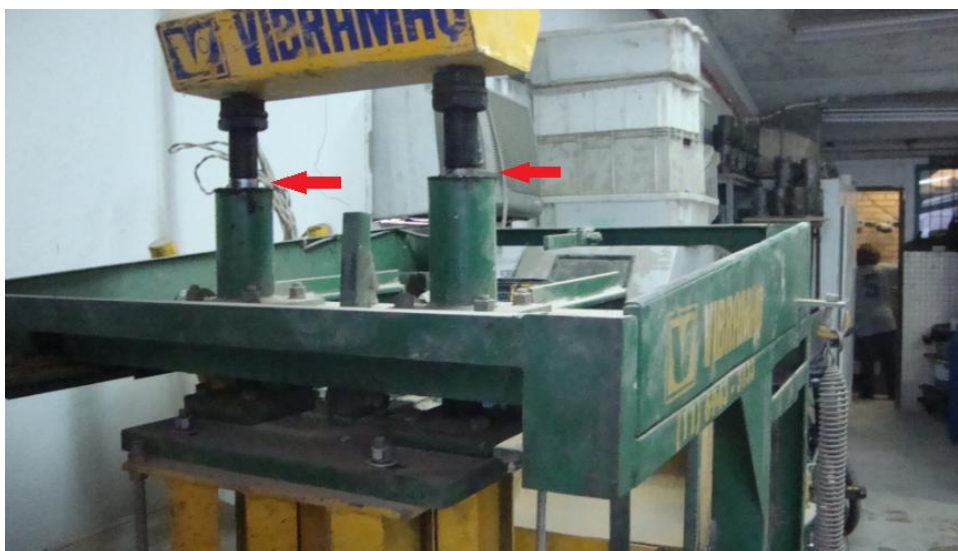
Figura 15 – Indicação do final do curso das hastes que mantém as extratoras ligadas ao contrapeso
