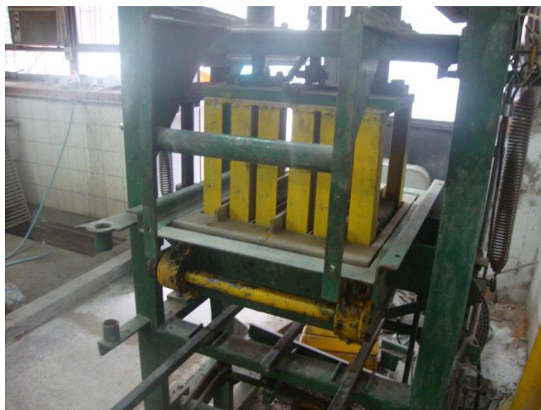
Figura 14 – Detalhe da vibroprensa utilizada
