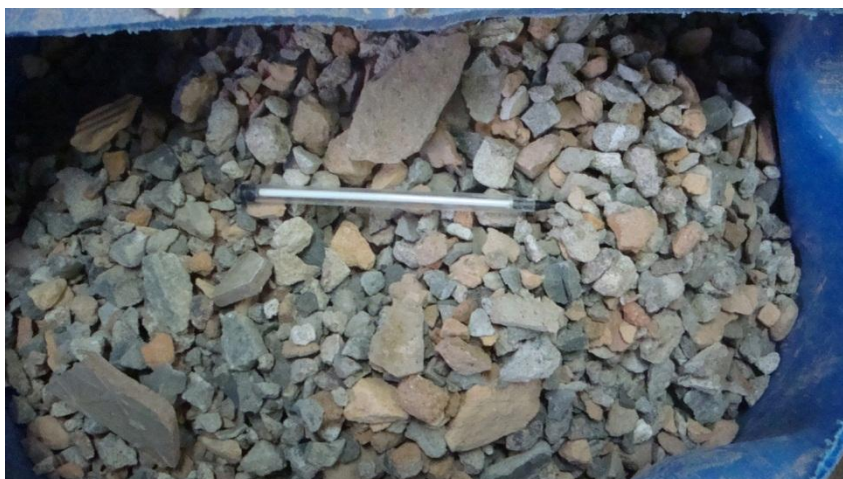
Figura 10 – RCD retido na peneira de malha #6,3 mm, após a primeira britagem
