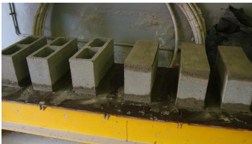
Figura 25 – Detalhe do capeamento dos blocos de concreto
