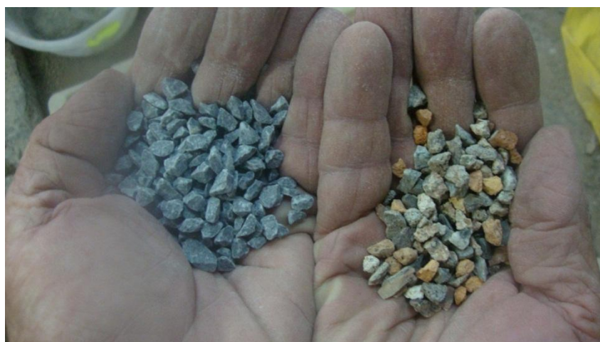
Figura 12 – Comparação entre o agregado graúdo natural, à esquerda, e o reciclado, à direita
