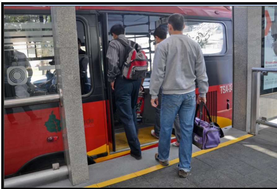
Figura 10 – Embarque em nível (piso alto) no BRT da Cidade do México
