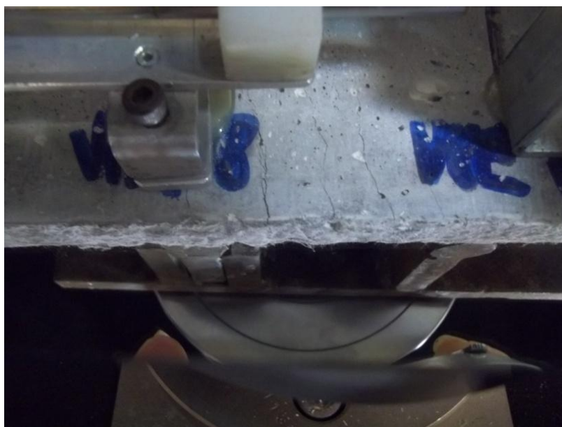
Figura 28 – Processo de múltipla fissuração durante a aplicação do carregamento
