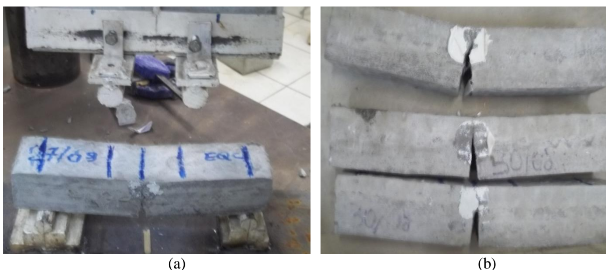
Figura 33 – (a) corpo de prova no fim do ensaio e (b) superfícies laterais após o término do ensaio
