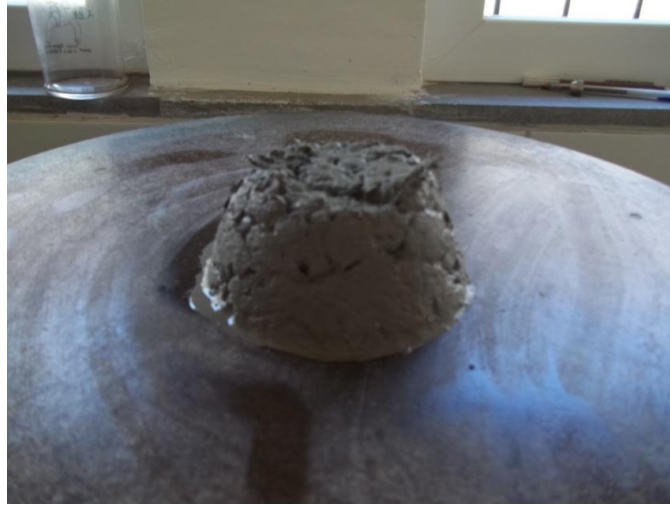
Figura 24 – Compósito ECC no momento da retirada do cone de aço
