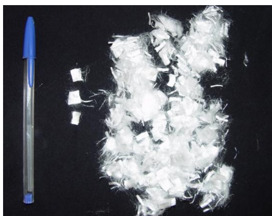
Figura 8 – Fibras de polipropileno de alta tenacidade adotadas na pesquisa
