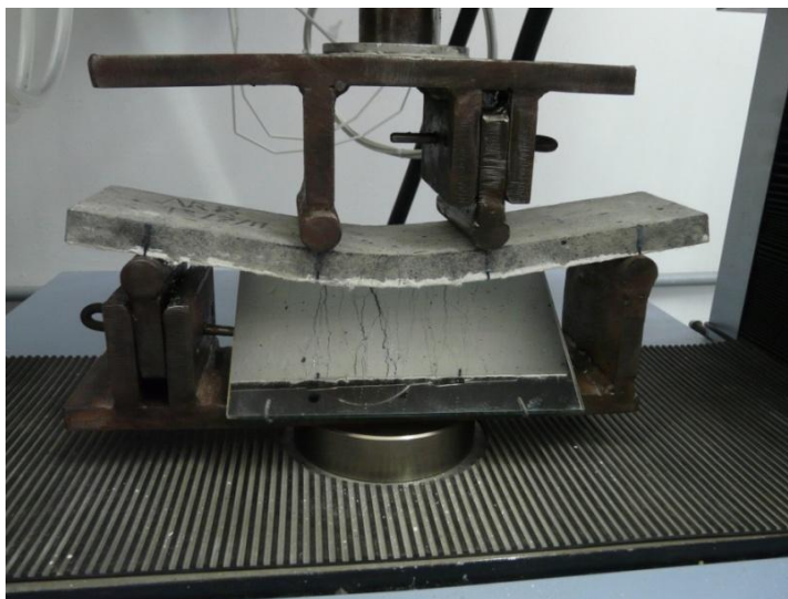
Figura 14 – Esquemática do ensaio de flexão: método Perrone
