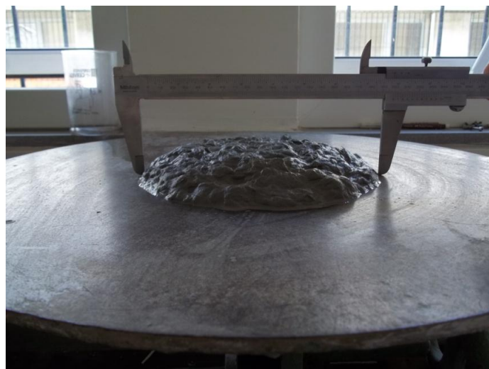
Figura 25 – Compósito ECC no fim do ensaio de trabalhabilidade
