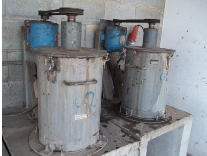
Figura 23 – Equipamentos adotados no ensaio de desgaste superficial por abrasão
