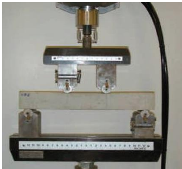
Figura 16 – Modelo genérico do ensaio de flexão a quatro pontos
