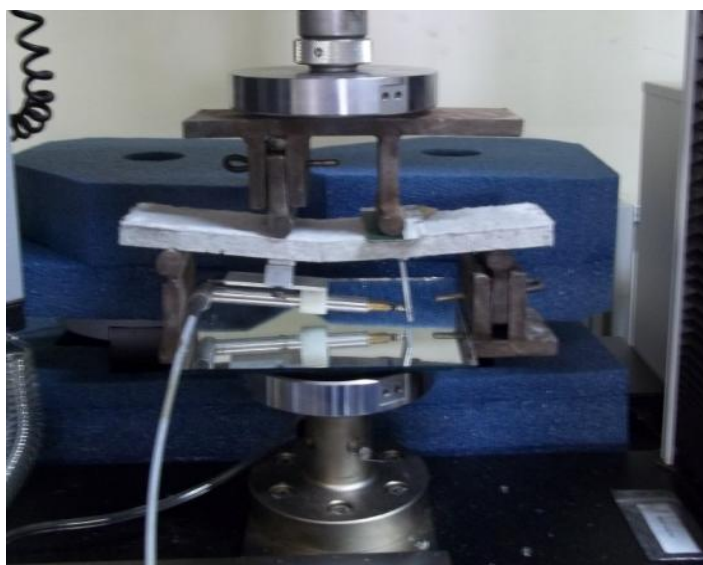
Figura 15 – Modelo adotado para o ensaio de flexão: método Perrone
