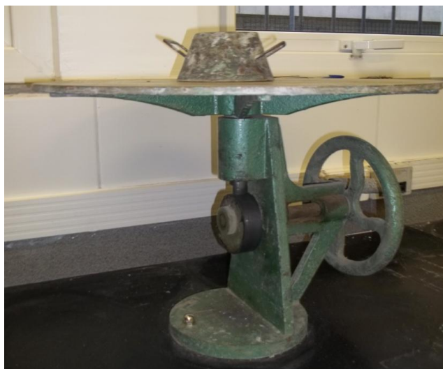
Figura 13 – Modelo genérico da flow table usada no ensaio
