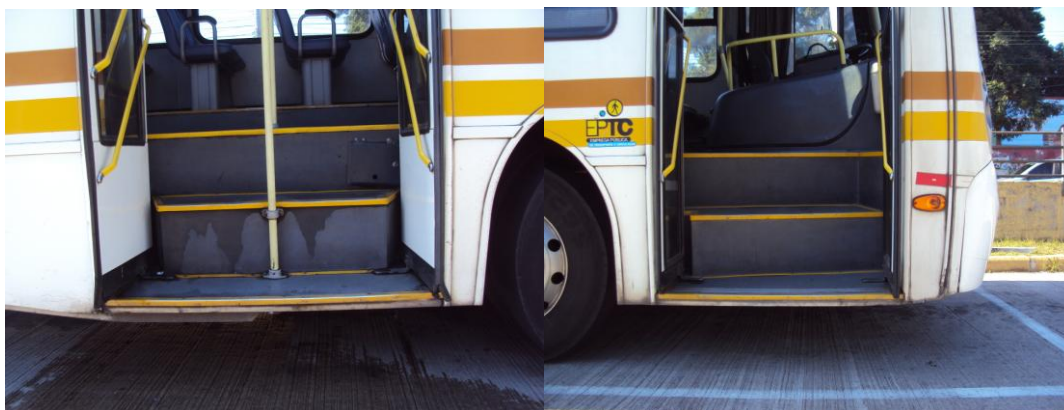
Figura 11 – Degraus nas portas de entrada e saída dos coletivos
