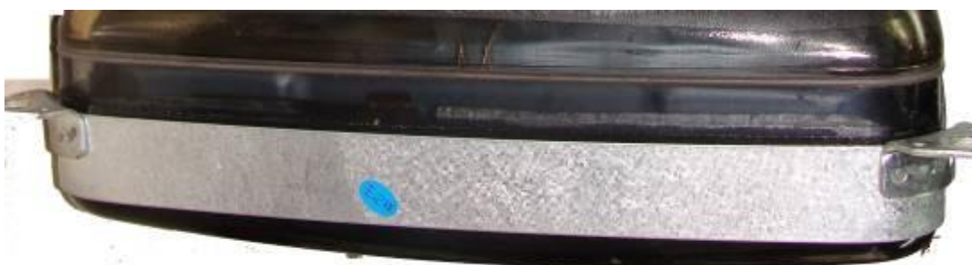
Figura 14 – Solda encontrada nos tubos CRT.
