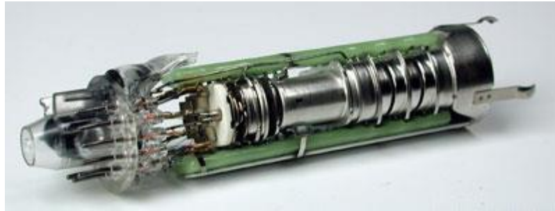
Figura 4 – Canhão de elétrons de um tubo de raio catódicos.
