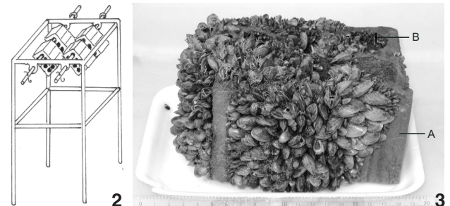
Figuras 2-3. Substrato artificial para acompanhamento do crescimento dos indivíduos adultos, na Praia do Veludo: (2) Desenho esquemático do suporte de ferro; (3) tijolo: (A) superfície avaliada, (B) superfície e perfurações avaliadas até a profundidade de 1cm.
