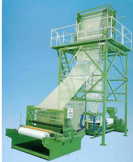
Figura 2: Processo de extrusão de filme tubular.
