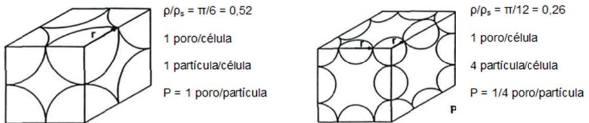
Figura 24: Microestruturas obtidas pelo empacotamento de esferas, mostrando dois tipos de empacotamento numa célula unitária.
