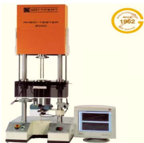
Figura 32: Reômetro capilar usado na confecção dos extrusados.
