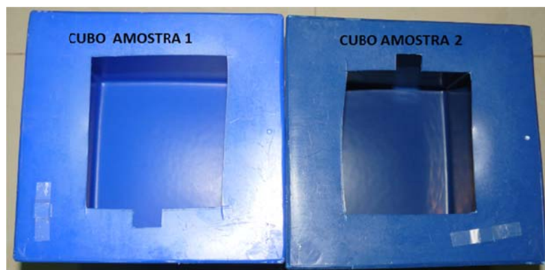
Figura 46: Peças obtidas no teste de rotomoldagem piloto
