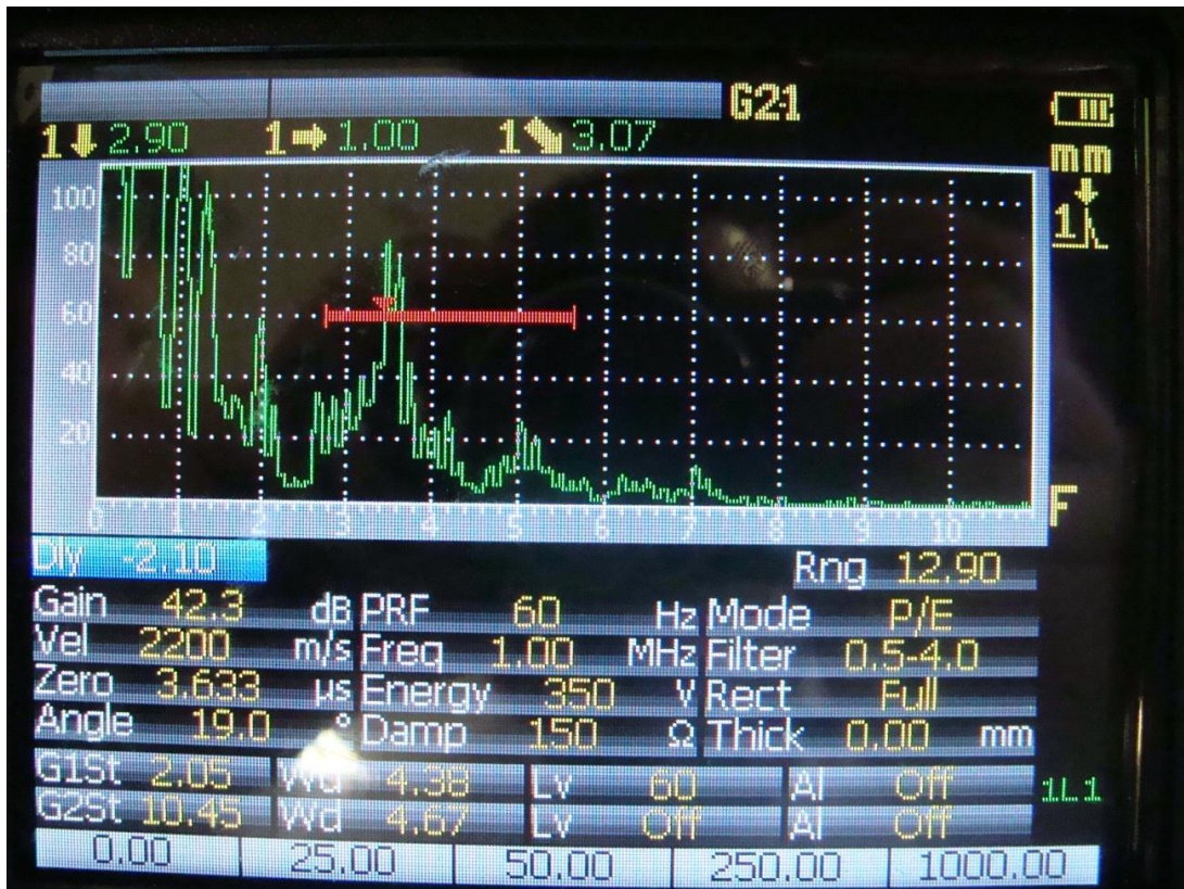
Figura 5.8 - Tela do equipamento Olympus-Epoch XT para a medida da velocidade transversal no sentido radial do tubo.
