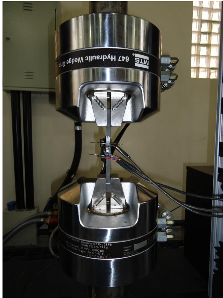
Figura 4.3 - Sistema de ensaio de tração no corpo de prova tipo halteres
