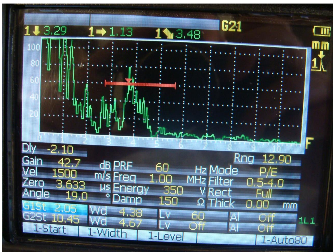
Figura 5.5 - Tela do equipamento Olympus-Epoch XT para a medida da velocidade transversal no sentido axial do tubo.
