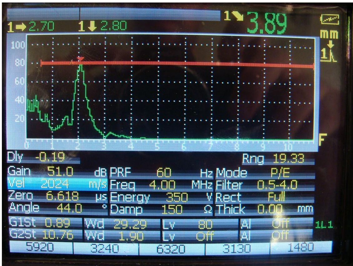
Figura 5.6 - Tela do equipamento Olympus-Epoch XT para a medida da velocidade longitudinal no sentido intermediário a 44° entre os eixo x e z
