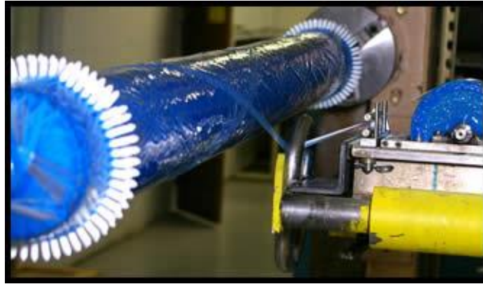
Figura 3.5 - Tubo fabricado pelo processo de enrolamento filamentar (S A Composites)
