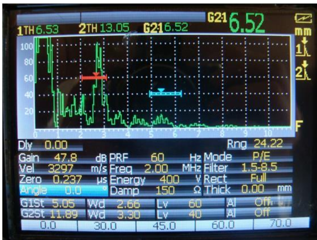
Figura 5.4 - Tela do equipamento Olympus-Epoch XT para a medida da velocidade longitudinal no sentido radial do tubo.
