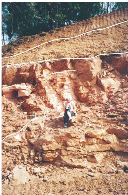
FIGURA 11 - Lente de arenito interderrame em corte da Rota do Sol, nas proximidades do Arroio Bernardes e Arroio do Padre. No topo do afloramento, blocos marcam a presença de colúvios quaternários.
