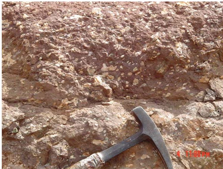
FIGURA 14 – Feição de topo do derrame, amígdalas preenchidas por calcita, zeolitas, quartzo e seus pseudomorfos.
