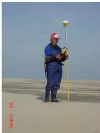
**Figura 18:** Monitoramento da duna com auxílio de GPS.
