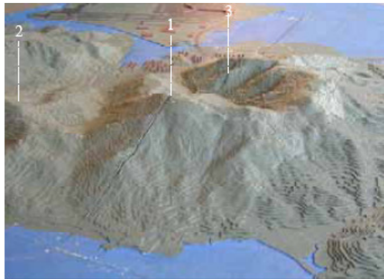
Figura 27- Modelo em escala de um terreno complexo típico empregado para experimentos em túneis de vento (DERICKSON et al., 2004).
