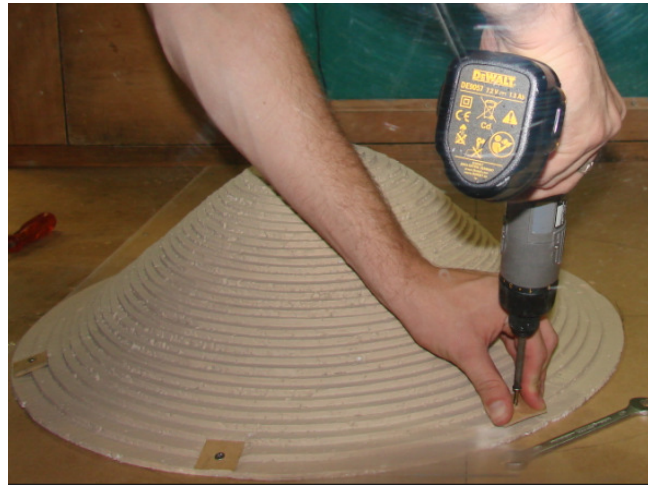
Figura 66 - Fixação dos modelos no piso do túnel.
