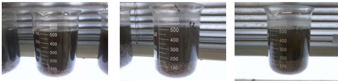
Figura 4.2: Ensaios de coagulação e floculação com cal hidratada, CC2 e polieletrólito.
