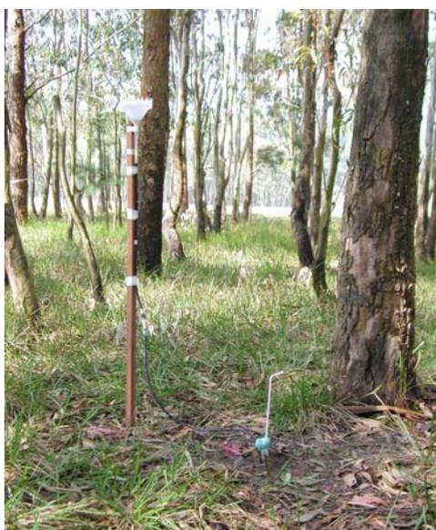
**Figura 13** - Detalhe do coletor utilizado para recolher amostras de precipitação bruta e de precipitação interna com periodicidade mensal
