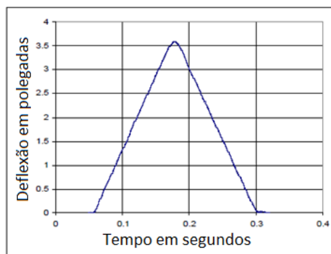
Comportamento da espuma sob um carregamento em alta velocidade (Fonte: Bhonge, 2008)
