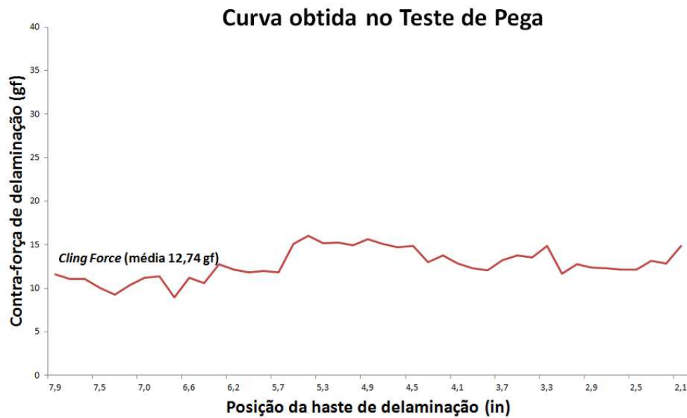
Figura 25: Curva da contra-força de delaminação de uma camada do filme ao longo do deslocamento da haste no Teste de Pega.
