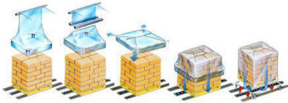
Figura 4: Sequência de aplicação do stretch hood para paletização de cargas [16].
