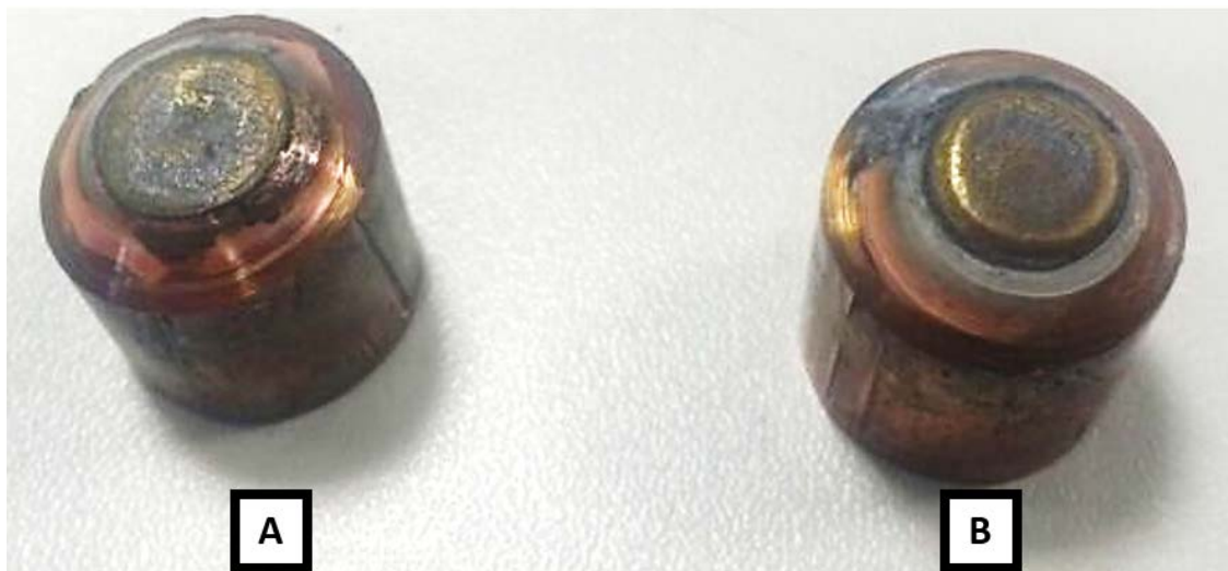
Figura 4.1 – (a) Eletrodo após teste com vazão de 2,6 L/min (diâmetro da face com 8,0 mm e presença de manchas no cobre); (b) Eletrodo após teste com vazão de 9,6 L/min (diâmetro da face com 7,3 mm).
