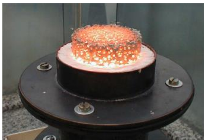
Figura 1.1 Chama estabilizada dentro de uma espuma cerâmica de carbeto de silício [Pereira, 2002].
