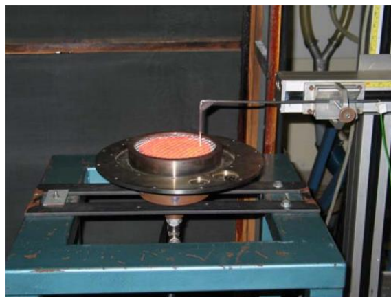
Figura 2.2 – Protótipo de um queimador poroso em funcionamento [Hayashi, 2005].
